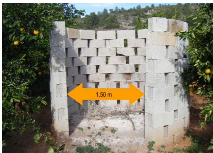
Apertura lateral o boca de alimentación de un quemador agrícola. Fuente: Norma Técnica de Quemadores Agrícolas (PPIFD Polinyà del Xúquer).
